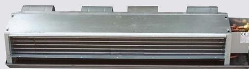
Estas unidades estão disponíveis com potências de 1,12 a 7,8 kW para arrefecimento e de 2,2 a 10,8 kW para aquecimento. Aplicação em tecto falso, com ocupação reduzida do espaço. Regulação da temperatura ambiente interna de forma rápida e mediana. Ventilador com três velocidades incorporadas. Permutador de 3 filas, em alumínio.
