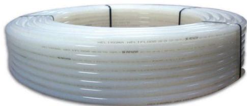
A barreira anti-difusão de oxigénio presente no tubo consiste numa fina película de EVOH, aplicada na camada exterior do mesmo durante o processo de fabrico, com o objectivo de criar uma estanquidade ao oxigénio e consequente aumento da durabilidade da instalação.
