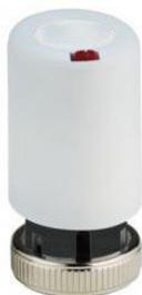
Cabeça de comando electrotérmico normalmente fechada para aplicação nas válvulas termostaticáveis dos colectores. A abertura ou fecho desta cabeça é controlada por um termostato ambiente ou outro controlo semelhante.
