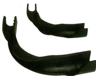
Curva guia reforçada para desvios de 90°, fabricada em material sintético e reforçada com fibra de vidro, com abertura lateral para inserir o tubo e com pestana de segurança. O objectivo é fazer subir o tubo desde o solo até aos colectores, proporcionando protecção mecânica ao tubo e evitando uma curva fechada.
