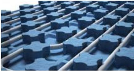
Placa base para Piso Radiante fabricada em EPS (Poliestireno Expandido). Moldado e microfundido mediante vapor de água, conseguindo uma total impermeabilidade à água. Capa exterior de polietileno de alta densidade cor azul. Sistema totalmente estanque sem possibilidade de pontes térmicas, sem necessidade de apoios para fixação da base e sem necessidade de grampos para o tubo.
