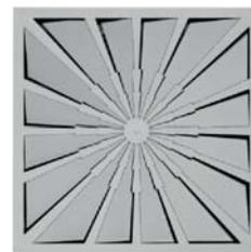
A face frontal do difusor e a chapa perfurada são feitas a partir de chapa galvanizada. A face frontal tem um acabamento termolacado à cor RAL 9010 (brilho 50%) ou em opção outro RAL. A chapa perfurada tem um acabamento termolacado à cor negra (RAL 9005). O pleno é feito a partir de chapa galvanizada.
