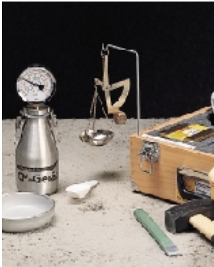
Medição de humidade de lajes em MAPECEM
