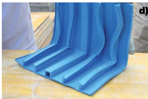
Fases de soldadura a 90° de Idrostop PVC BE: a) corte a 45° das hastes e do bolbo de Idrostop PVC BE; b) as duas abas a soldar são aquecidas com o leister; c) as duas abas são pressionadas uma contra a outra e continua-se a aquece-las com o leister; d) waterstop soldado a 90°
