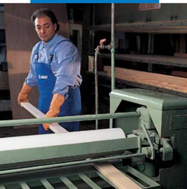
Espalhamento a rolo de Adesivil D3 para a junção de elementos em madeira
