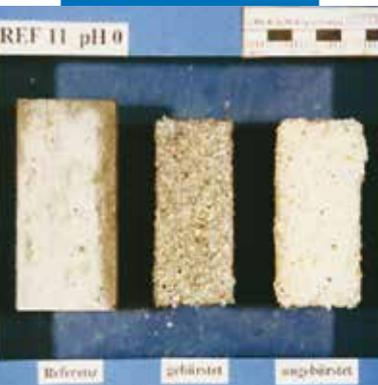
Argamassa de referência segundo as "Diretivas para o controlo das argamassas utilizadas nos sistemas de esgotos"
