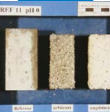
Argamassa de referência segundo as "Diretivas para o controlo das argamassas utilizadas nos sistemas de esgoto"
