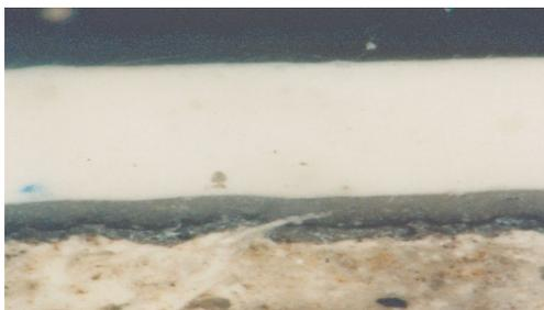
É evidente tanto a penetração do primário na placa de cimento-amianto, como a eficácia da capsulação das fibras de amianto garantida já pelo primário
