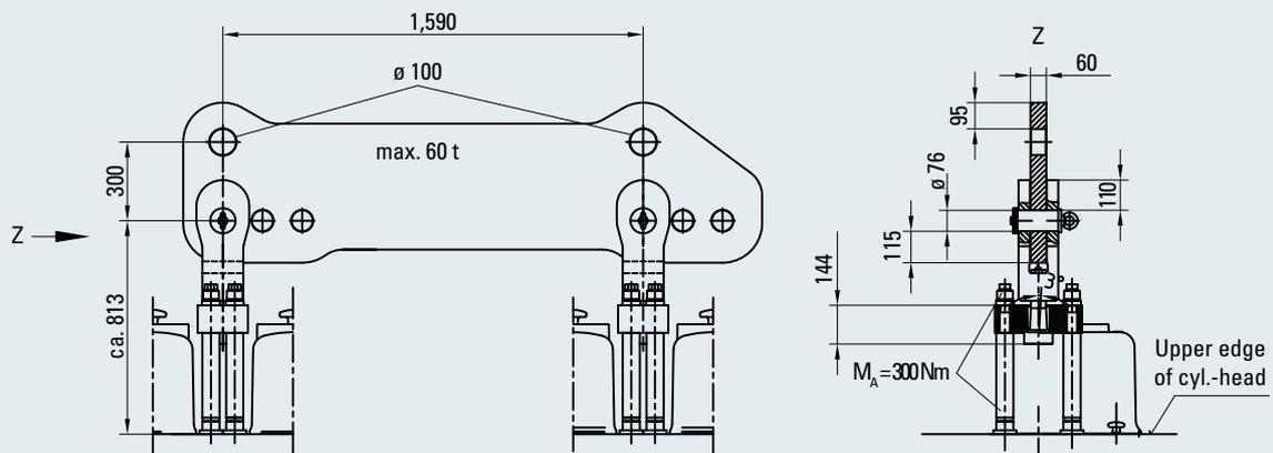
Fig. 21-1 Spreader bar
