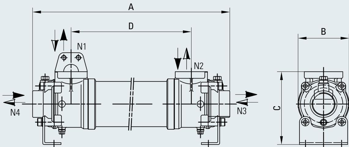
Fig. 5-22 Fuel oil cooler for MDO operation DH3
