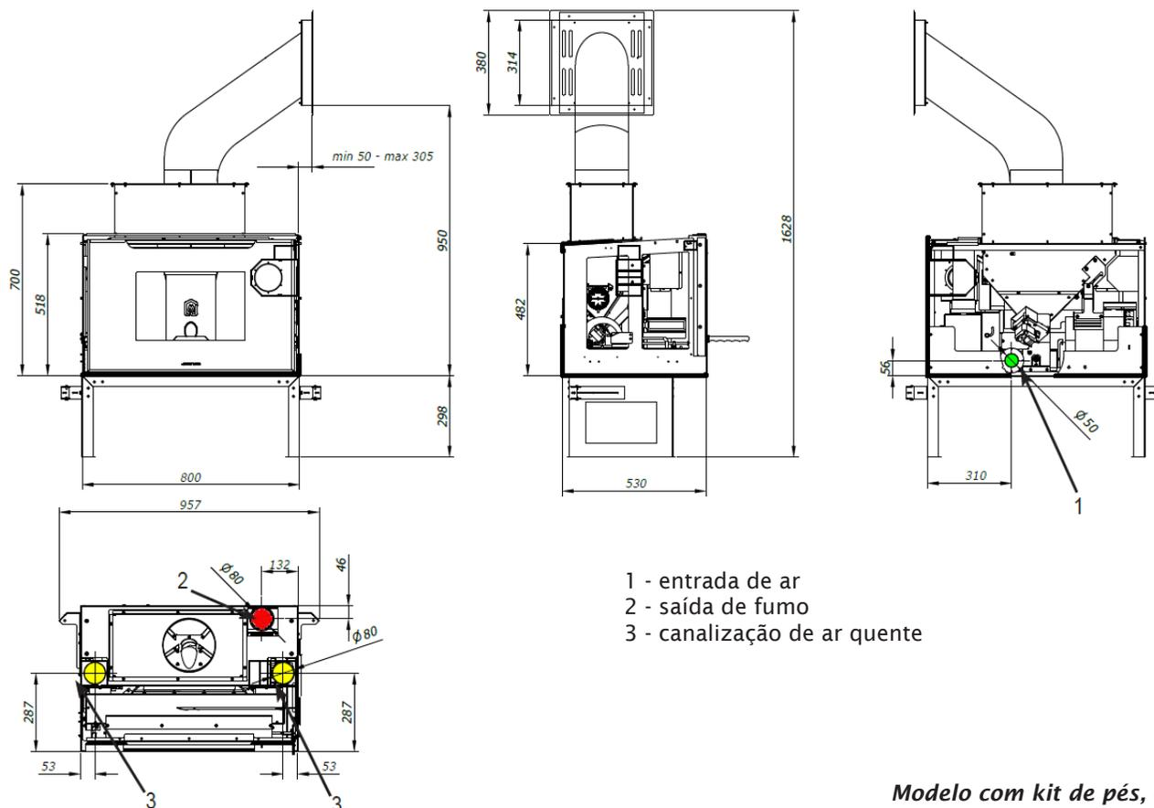
*Modelo com kit de pés, carga lateral e tanque de 11 kg*
