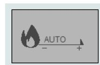
In modalità Auto l'apparecchio è programmato per regolare la potenza di combustione in funzione delle richieste delle sonde/termostati.
