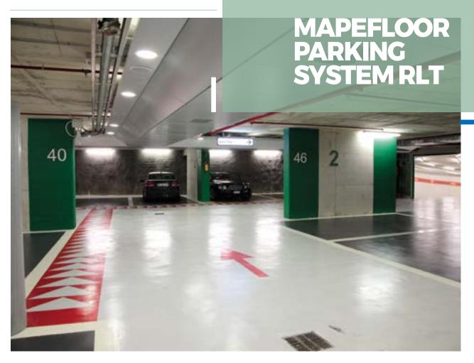
Sistema epoxídico multicamadas contínuo, para áreas pedonais ou de veículos sujetos a tráfego ligeiro de acordo com o Guideline of the German Committee on Reinforced Concrete OS 8 e os sistemas de proteção das superfícies em betão segundo EN 1504-2. Espessura 0,8 -1,2 mm.
