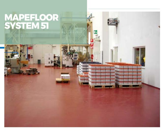
Sistema epoxídico hidro-disperso, opaco, multicamadas, permeável ao vapor, com efeito antiderrapante para pavimentos industriais com espessura média de 3 mm.
