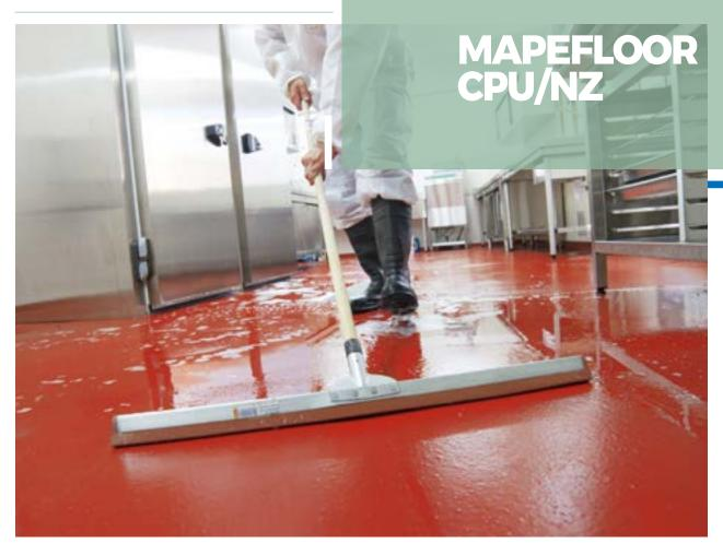
Sistema à base de formulado poliuretano-cimento, de elevada resistência química, mecânica e aos choques térmicos, de aplicação fácil, para revestimentos antiderrapantes de pavimentos industriais numa espessura compreendida entre 4 e 6 mm.
