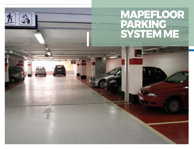
Sistema poliuretânico multicamadas contínuo, para áreas pedonais ou de veículos sujeitos a tráfego intenso, com elevada capacidade de crack-bridging dinâmico para a proteção de áreas de estacionamento mesmo exteriores, de acordo com o Guideline of the German Committee on Reinforced Concrete OS 11b e os sistemas de proteção das superfícies em betão segundo EN 1504-2. Espessura 4-4,5 mm.
