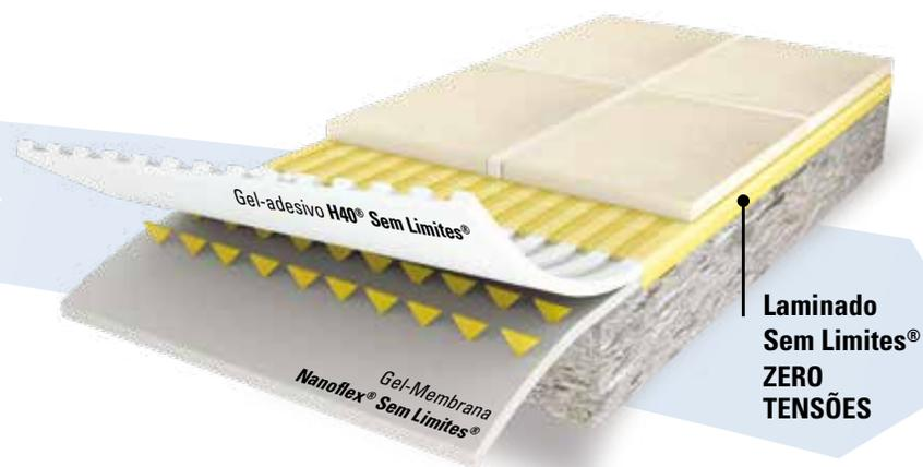
A exclusiva matriz mineral cristalina do Geoligante do **H40® Sem Limites®** capta e envolve os terminais livres da nova matriz polimérica do **Nanoflex® Sem Limites®**, produzindo uma fusão estrutural químico-mecânica formando o novo **Laminado Sem Limites®**.
