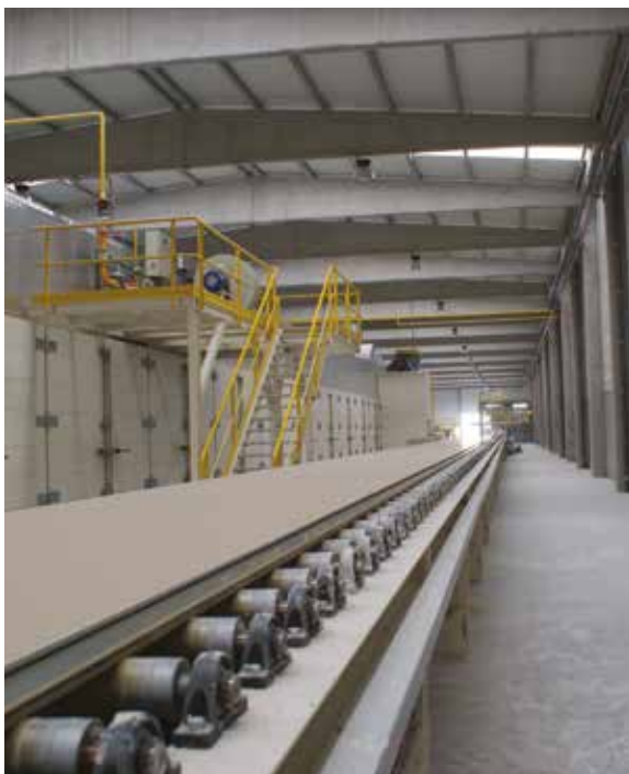
Figura 1: Fabrico das placas de gesso laminado.
