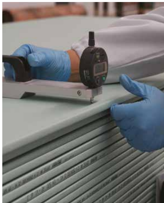
Figura 1: Fabrico das placas de gesso laminado.
