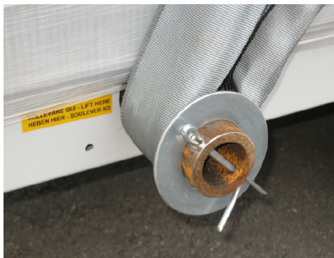
Fig. 3 Detalhe do engate da cinta ao tubo de elevação
