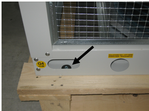
Fig. 1 Detalhe da posição do parafuso de fixação da unidade na paleta
