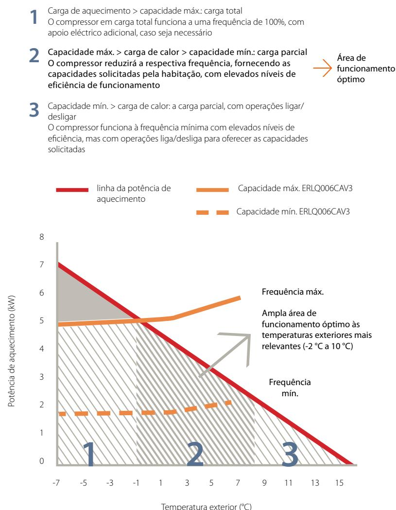
O funcionamento a carga parcial e a área de funcionamento óptimo do compressor podem ser ilustrados por uma instalação típica na cidade de Paris
