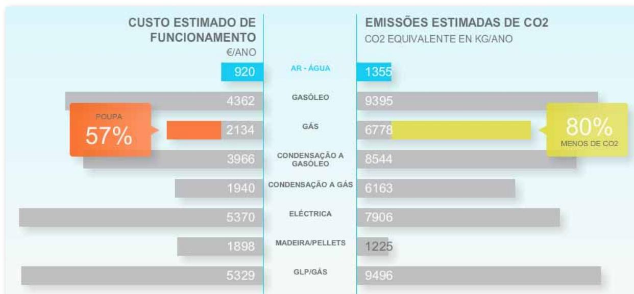
\* Simulação para uma moradia nova (quarto no piso de cima) com emissores de baixa temperatura, para 5 pessoas e uma superfície aquecida de 220 m<sup>2</sup>, tendo em conta as condições climatéricas do Litoral Centro de Portugal, um preço da electricidade de 0,17 EUR/kWh e um preço do gás de 0,06 EUR/kWh.
