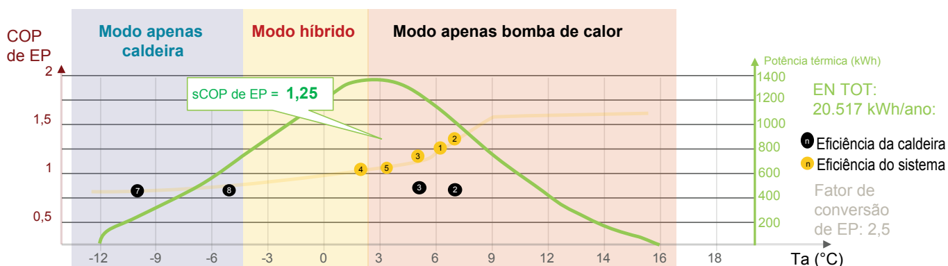
Figura 40: Gráficos relativos ao teste no terreno próximo de Estugarda, Alemanha: 1) Potência térmica por grau Celsius [kWh/°C] (linha verde); 2) Eficiência do sistema (linha amarela e pontos) e eficiência da caldeira (pontos pretos); ambas em termos do COP de PE.
