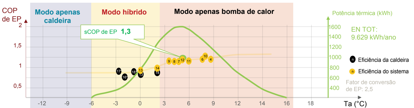
Figura 44: Gráficos relativos ao teste no terreno próximo de Rimini, Itália: 1) Potência térmica por grau Celsius [kWh/°C] (linha verde); 2) Eficiência do sistema (linha amarela e pontos) e eficiência da caldeira (pontos pretos); ambas em termos do COP de PE.
