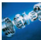
Os **compressores de tipo scroll** fornecidos nos modelos de elevada capacidade Daikin Altherma (11 a 16 kW) foram concebidos como um dispositivo compacto, robusto e silencioso para garantir a máxima fiabilidade operacional (sem válvulas e uniões de ligação oscilante integradas) e eficiência (através de um fluxo inicial baixo e de uma taxa de compressão constante).
