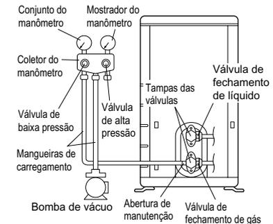
1) Ligue o lado da projecção da mangueira de carga (que sai do tubo de distribuição) à porta de serviço da válvula de corte.
