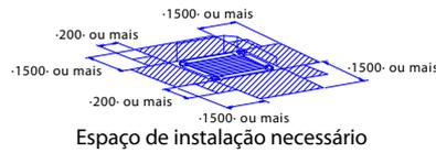
Se uma saída de insuflação for fechada com o kit opcional "elemento para tamponar", o espaço de instalação necessário nesse lado é de -500mm, em vez de -1500mm.
