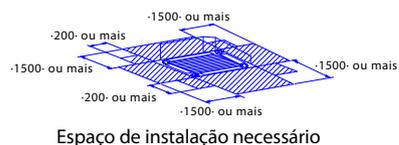
Se uma saída de insuflação for fechada com o kit opcional "elemento para tamponar", o espaço de instalação necessário nesse lado é de -500 mm, em vez de -1500 mm.
