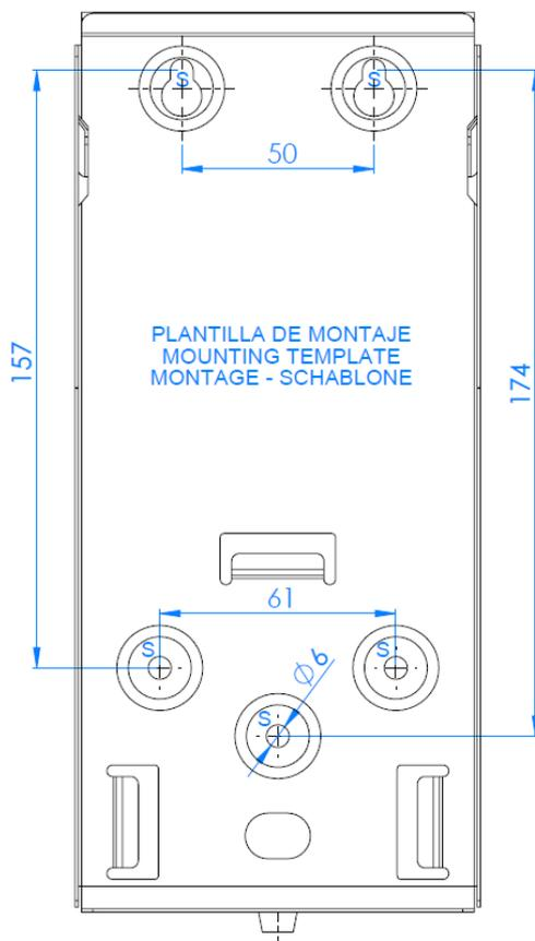
**ATENCIÓN:** no instalar este dosificador de jabón dentro de la ducha, ya que sus componentes eléctricos pueden resultar seriamente dañados por el agua y que el dosificador deje de funcionar. En caso de optar por la configuración con transformador eléctrico, instalar éste lejos de cualquier fuente de agua.
