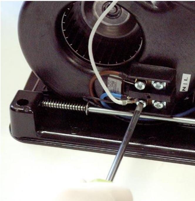
Desconectar el cable de la resistencia que va al temporizador.
