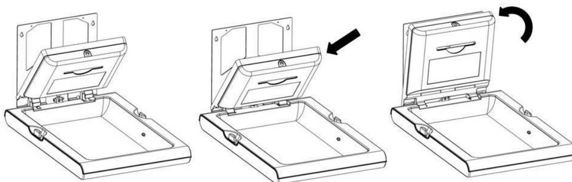
Abrir el dispensador de toalhinas con la llave especial suministrada. Los cuatro orificios de fijación de este dispensador de toalhinas a la estructura de fijación del trocador de fraldas quedarán a la vista.
