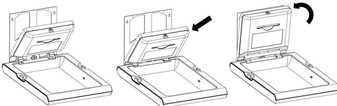
Abrir el dispensador de sábanitas con la llave especial suministrada. Los cuatro orificios de fijación de este dispensador de sábanitas a la estructura de sujeción del cambia pañales quedarán a la vista.
