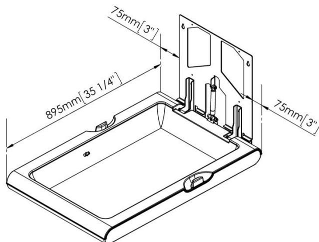
La hauteur recommandée d'installation est à 800 mm du sol jusqu'à la partie la plus basse de la table à langer. Le croquis suivant montre à quelle hauteur les trous doivent être percés pour que la table soit installée à la hauteur recommandée :
