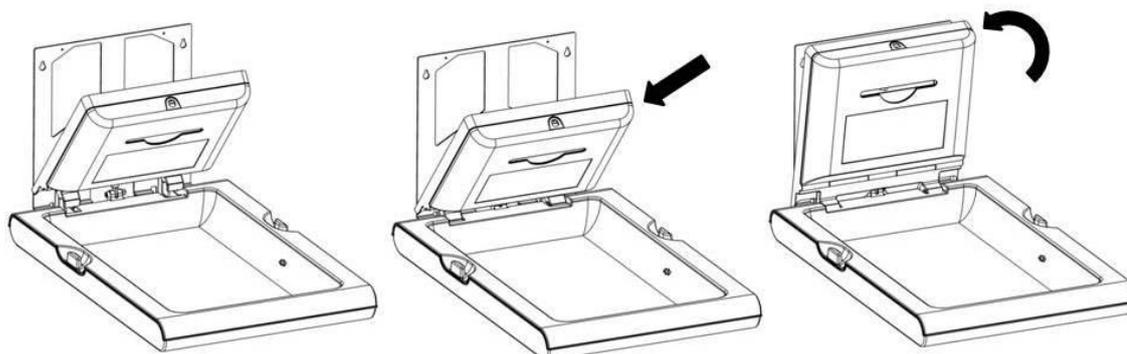
Ouvrir le distributeur de draps à l'aide de clé spéciale fournie. Les quatre orifices de fixation de ce distributeur de draps à la structure de fixation de la table à langer resteront visibles.
