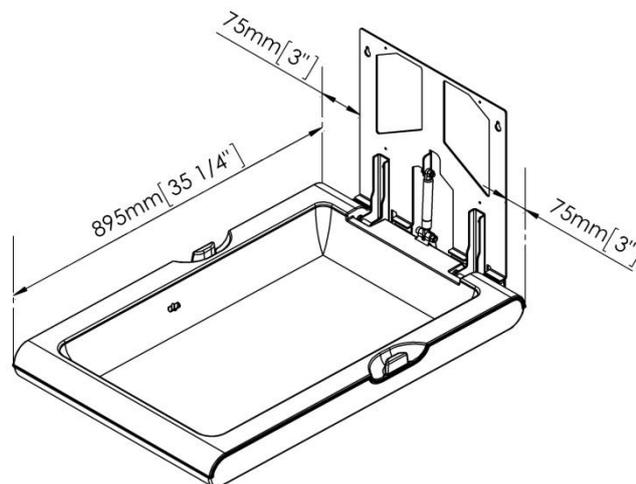
Für die Montage empfehlen wir einen Abstand von 800 mm zwischen Boden und niedrigstem Teil des Wickeltisches. Die nachfolgenden Skizzen zeigen auf welcher Höhe die Löcher gebohrt werden müssen, um den Wickeltisch auf der empfohlenen Höhe anzubringen:
