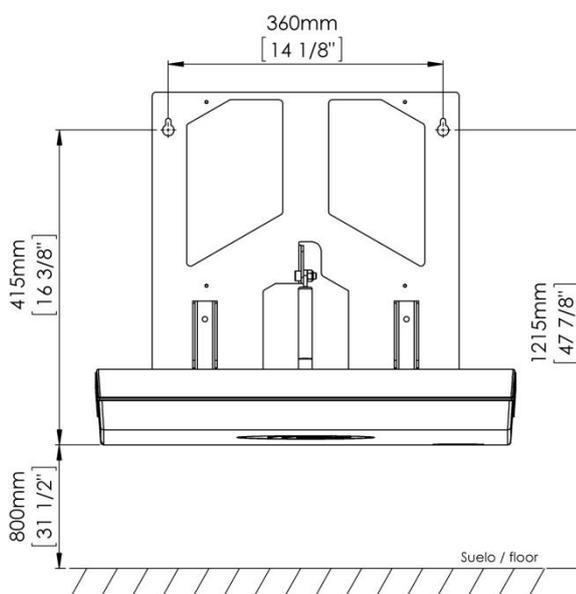
Seguindo o esquema anterior marque em cima da parede os furos superiores da estrutura de fixação do trocador de fraldas com o lápis. É muito importante assegurar que as localizações marcadas com o lápis para os furos de montagem estão no mesmo nível que antes de realizar as perfurações.
