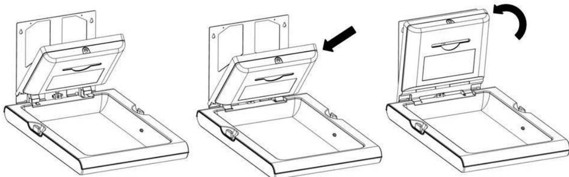
Öffnen Sie den Auflagenspender mit dem mitgelieferten Spezialschlüssel. Jetzt können Sie die vier Befestigungslöcher für den Auflagenspender an der Halterung sehen.
