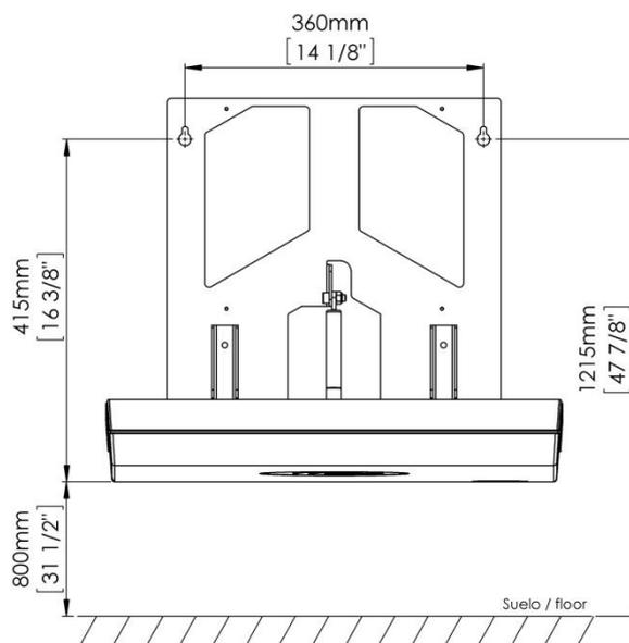
En suivant le schéma antérieur, marquer à l'aide d'un crayon sur le mur les deux trous supérieurs de la structure de fixation de la table à langer. Il est important de s'assurer que les emplacements marqués au crayon pour les trous de montage soient au même niveau avant de percer.
