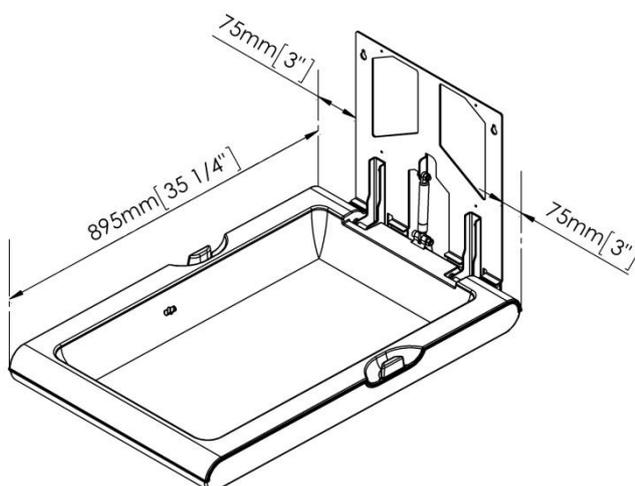
Рекомендованная высота установки — 800 мм от пола до самой нижней части пеленального стола. Следующий рисунок показывает, на какой высоте должны быть сделаны отверстия, чтобы пеленальный стол оказался установлен на рекомендованной высоте:
