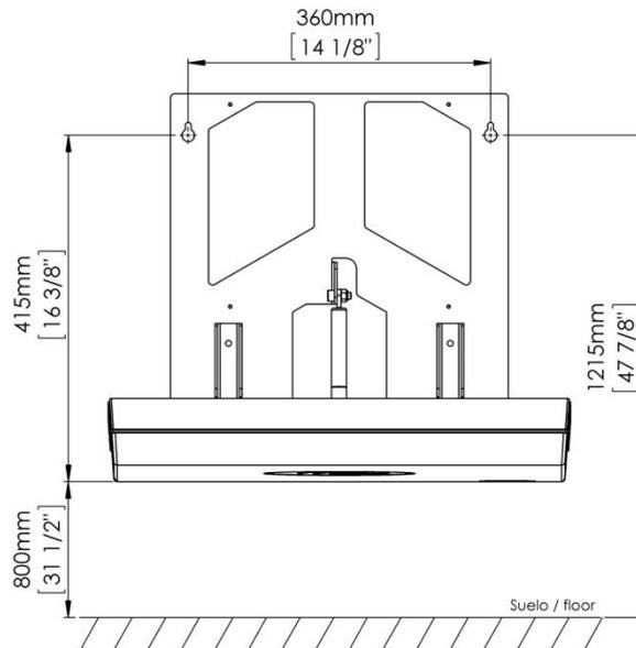
بناء على الرسم السابق، قم باستخدام القلم الرصاص لتحديد أماكن ثقب الجزء العلوي لهيكل تثبيت سرير تغيير الحفاضات على الحائط. من المهم جدًا التأكد من أن الأماكن التي قد تم تحديدها بالقلم الرصاص لتقوُّب التركيب تقع على المستوى نفسه قبل عمل الثقب.
