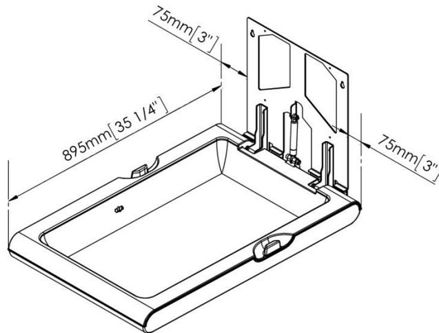
La altura recomendada de instalación es de 800 mm desde el suelo hasta la parte más baja del cambia pañales. El croquis siguiente muestra a qué altura deben realizarse los agujeros para que el cambia pañales quede instalado a la altura recomendada:
