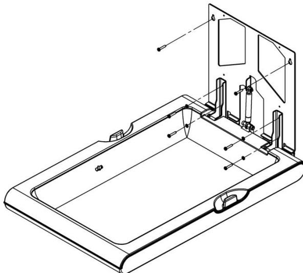
Vérifier que les six vis de fixation de l'unité au mur ont été correctement serrées et que la table à langer est fermement fixée au mur.
