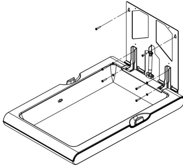
Verificare che le sei viti di fissaggio a parete dell'unità siano state avvitate in modo corretto e che il fasciatoio sia assicurato saldamente al muro.
