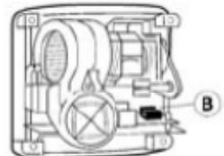
Die feste Installation muß von dem Anschlussgerät Abschaltungsmittel einfügen, die mindestens 3 mm von allen den Polen entfernt sind. Bei der Installation sind die Schutzzonen gemäß VDE 0100 zu berücksichtigen. Der Händetrockner darf ausschließlich auf einer geschlossenen Oberfläche installiert werden (Mauer, Leichtbauwand oder ähnliches).
