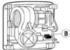
Должны быть предусмотрены средства отключения от сети питания при минимальном расстоянии между контактами 3 мм на всех полюсах. Данные средства отключения должны быть включены в стационарную установку. В ходе установки должны быть предусмотрены участки безопасности в соответствии со стандартом VDE 0100. Сушилка для рук должна устанавливаться исключительно на закрытой поверхности (стена, перегородка и т.п.).
