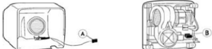
Se deben prever medios de desconexión de la red de alimentación, con una separación de contacto de al menos 3 mm en todos los polos. Dichos medios de desconexión deben ser incorporados a la instalación fija. Durante el proceso de instalación deben ser consideradas las áreas de protección según Norma VDE 0100.
