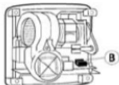
L'installation fixe doit inclure les moyens de déconnexion de l'appareil du réseau d'alimentation, avec une séparation de contacte de 3 mm minimum pour tous les pôles.
