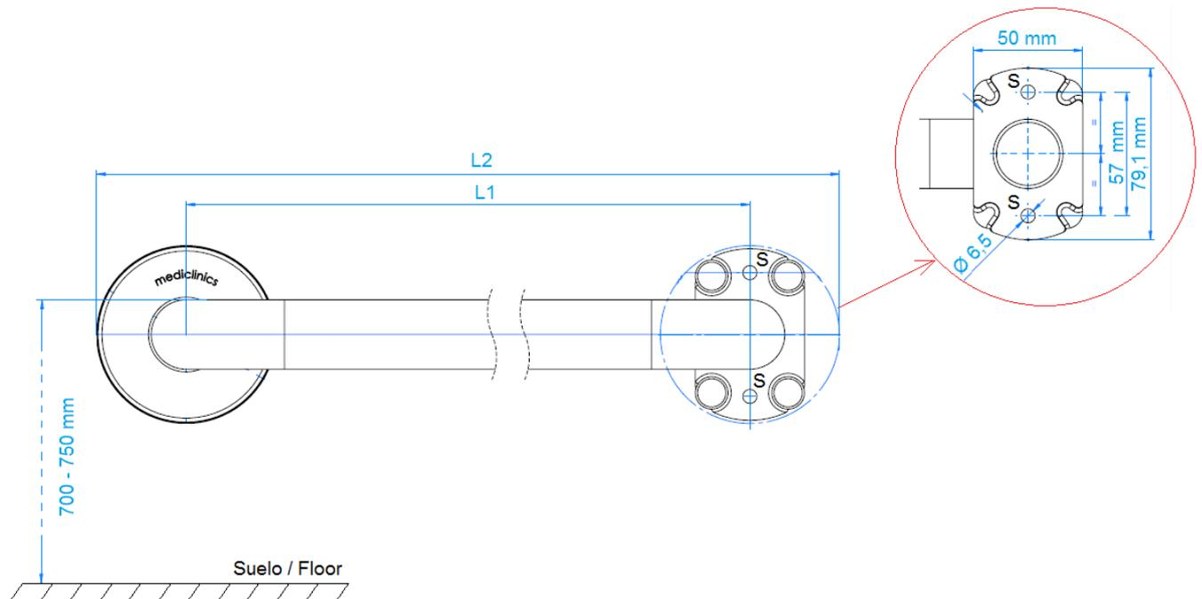
Cuando la barra se monte en posición horizontal, su parte superior debe quedar entre los **700 y los 750 mm** de altura, tal y como se indica en el apartado "Barras de apoyo", "Sección SUA 9, Accesibilidad" del "Documento Básico SUA Seguridad de utilización y accesibilidad".
