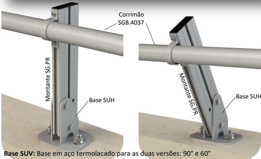
A guarda SG.PRH permite a proteção coletiva permanente em locais técnicos não acessíveis ao público. Este sistema dispõe de diferentes bases que permitem a adaptação da guarda consoante as condicionantes técnicas do local (geometria do murete, resistência para fixação, existência de impermeabilização e/ou de isolamento térmico).
