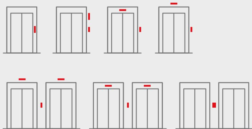
Escolha a melhor combinação para os patamares para instalações simplex ou multiplex, com montagem à superfície ou na parede.
