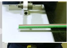
Cortar o tubo perpendicularmente ao seu comprimento, usando uma ferramenta que garanta um corte limpo e preciso.
