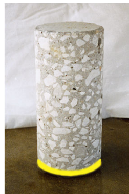
Com Hidrófugo Topeca. Forma-se uma verdadeira barreira à ascensão capilar.
