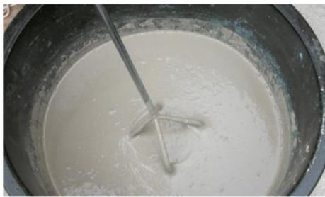
1. Misturar mecanicamente os 2 componentes, utilizando um misturador com velocidade lenta (juntar o componente A ao componente B) até obter uma pasta fluida e sem grumos.
