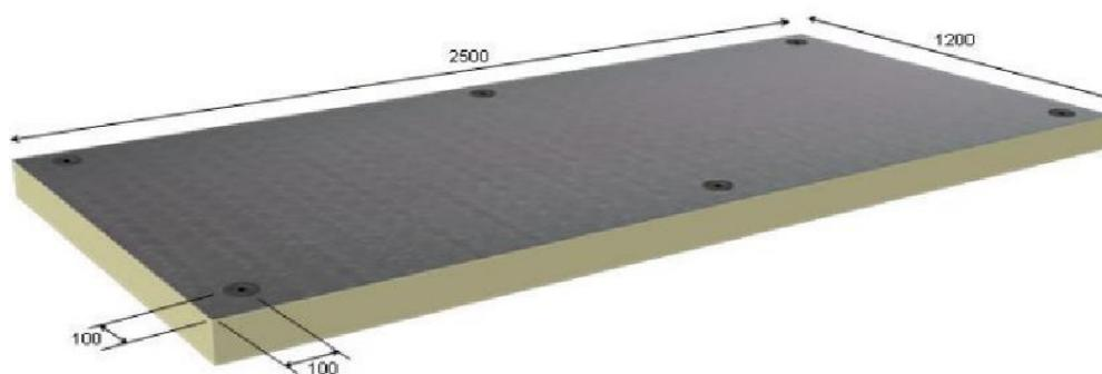
Figura 2. Placas 2500x1200 mm: 2 fixações/m<sup>2</sup>.
