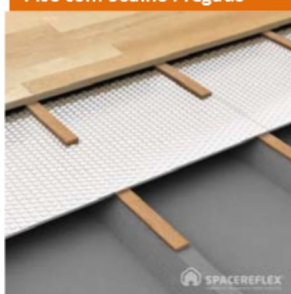
Piso com Soalho Pregado
