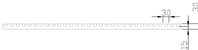
Fig 1: Perfil tipo dos painéis Wave.
