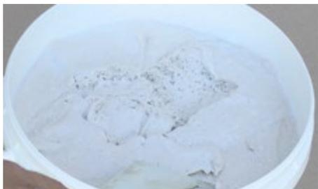
1. Misture a pasta adesiva Toflex, antes de aplicar para obter uma pasta homogênea e de fácil aplicação.
