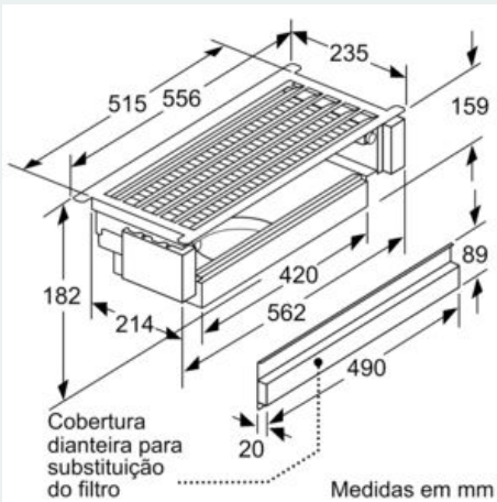
Medidas em mm Instalação do exaustor plano com conjunto de recirculação do ar
