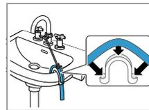
Fixe a mangueira de escoamento de água com um tubo curvo e proteja-a.
