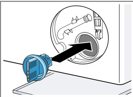
5. Coloque a tampa da bomba e aperte-a até ao batente.
