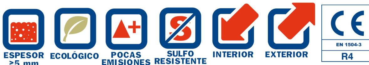
Mortero de reparación R4 monocomponente de alta resistencia para grandes espesores. Producto a base de cementos sulfuresistente, áridos seleccionados y aditivos, reforzado con fibras.
