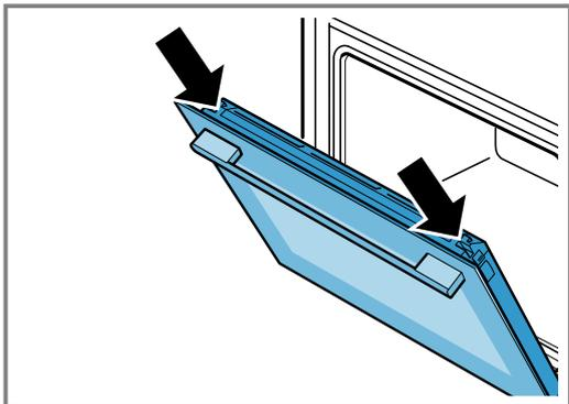
3. Abra completamente a porta do aparelho e pressionar no sentido do aparelho.
