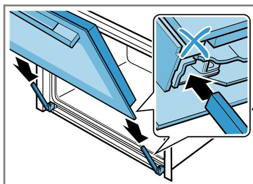
2. Pressione com ambas as mãos, pelo lado de cima, à esquerda e direita, sobre a moldura da porta, para verificar se a porta do aparelho foi inserida até ao batente.
