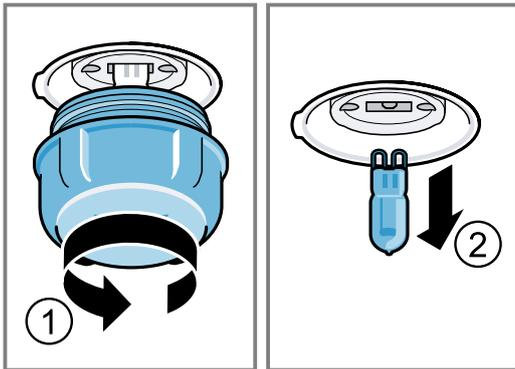
4. Insira a nova lâmpada de halogéneo e pressione-a com firmeza no suporte.
