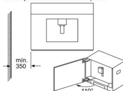
Na utilização da limitação de 92° da dobradiça (peça de reposição n.º 00636455), a distância até à parede é apenas 100 mm.
