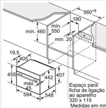
Se o aparelho compacto for instalado por baixo de uma placa de cozinhar, tem de ser observada a seguinte espessura da bancada (se necessário incl. estrutura inferior).
