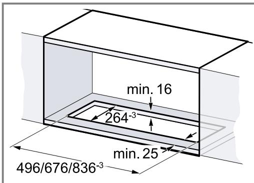
2. Crie o recorte para o tubo de extração acima do móvel embutido ou atrás do móvel embutido.
