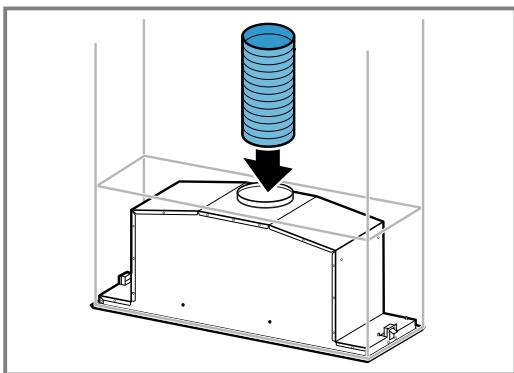
2. Establecer la conexión con la abertura de salida de aire.
