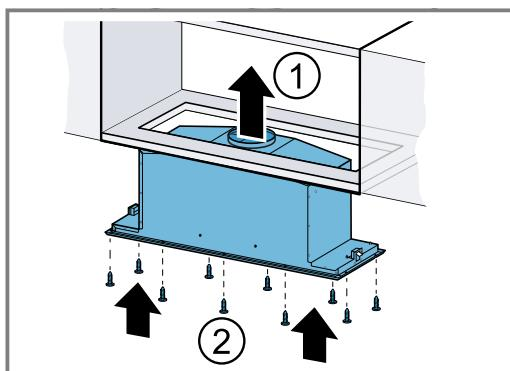
**2. Aperte os parafusos de fixação.**
