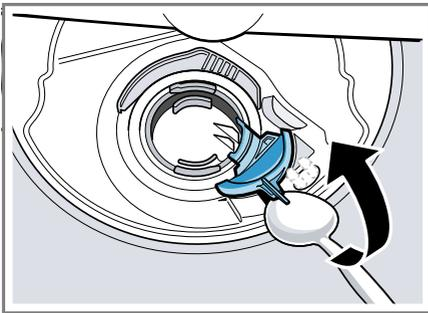
6. Levante a tampa da bomba de forma inclinada para dentro e retire.
