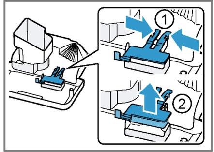
Desmonte a indicação mecânica do nível de enchimento e limpe com um pano húmido.
