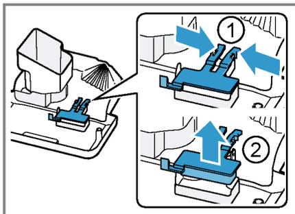
Desmontar el indicador mecánico del nivel de llenado y limpiar con un paño húmedo.
