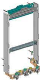
Ligação horizontal com estrutura de suporte Estrutura: P 70 mm Caldeira e estrutura: A 713 x L 400 x P 370 mm
