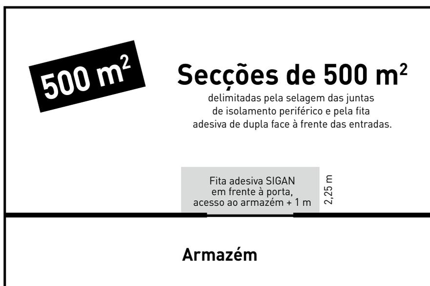
Cada secção de 500 m<sup>2</sup> pode incluir áreas de rotação, de líquidos, entradas para o armazém, que necessitam também da instalação com fita adesiva de dupla face.
