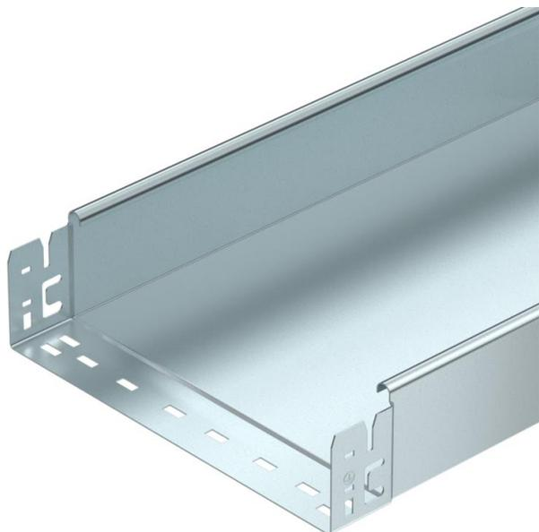
Caminho de cabos em chapa não perfurado com união de encaixe rápido integrada. O comprimento útil do caminho de cabos em chapa é de 3.000 mm. A ligação equipotencial contínua é garantida sem componentes adicionais.
