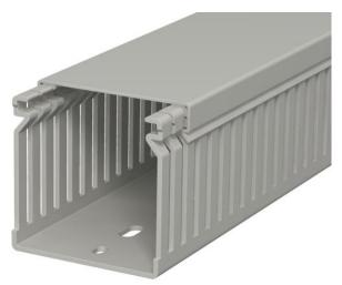
Calha de cablagem inclui tampa e base perfurada para colocação horizontal e vertical de cabos e linhas elétricas no quadro de distribuição. Versão métrica da calha. A medida nominal do tamanho do sistema corresponde à medida interna das calhas. A quebra das barras pode ocorrer sem ferramentas. A execução no pavimento é possível através de pontos de rutura nominais. Testado de acordo com a DIN EN 50085-2-3. Comprimentos especiais disponíveis mediante pedido.
