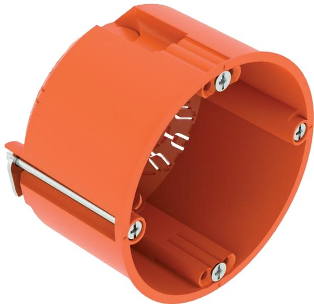
Caixa de aparelhagem para utilização em paredes ocas com uma profundidade de instalação de pelo menos 47 mm e uma espessura de placa de 5 - 40 mm.
