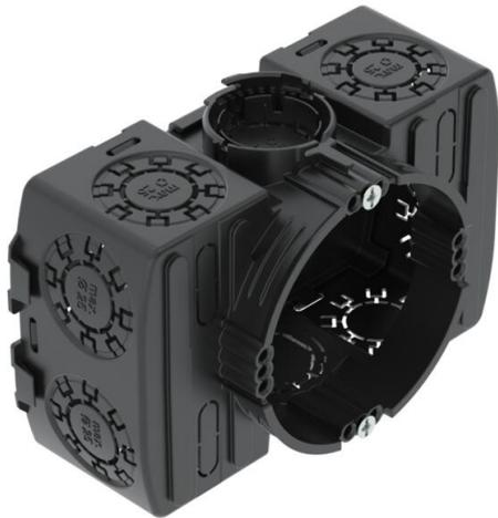
Caixa de eletrônica de encastrar com espaço de ligação lateral, formato retangular, para utilização em alvenaria com uma profundidade de instalação de pelo menos 50 mm.
